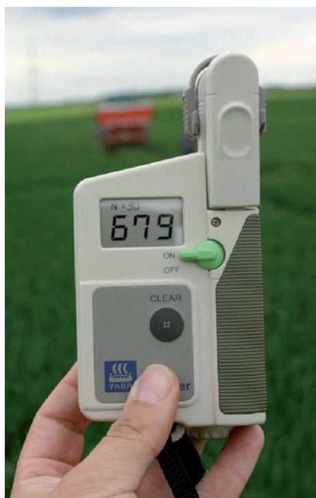
Slika 8: Pimer merilca koncentracije dušika na osnovi klorofila
