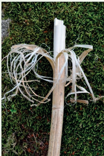
Steblo konoplje: prečni prerez, vlakno ločeno od sredice [5]
