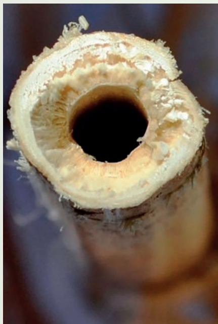
Steblo konoplje: prečni prerez, vlakno ločeno od sredice [5]
